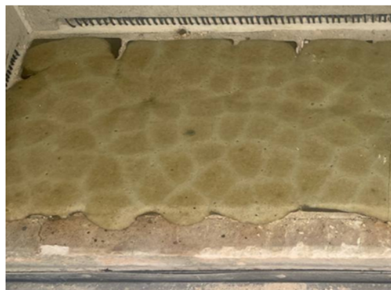
Рисунок 1. Растекшиеся образцы алюмосиликатного клинкера в муфельной печи.
