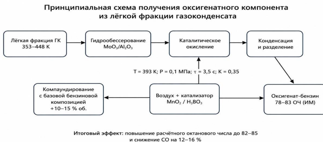
Рисунок 1. Схема получения и применения оксигенат-бензина из лёгкой фракции газоконденсата
